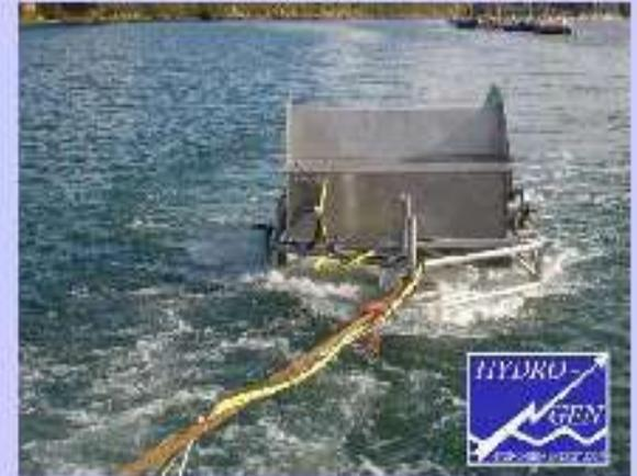
Prototypé de 10 kW en test mai 2006 (remorquage dans l'Aber Wrach) et en 2008 en Rade de Brest
